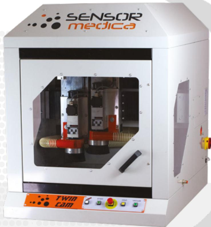
y elevado rendimiento: un par de plantillas se fabrica en un rango de entre 10 y 6 minutos. La fresadora Twincam, única en su género, es un sistema a 4 ejes independientes con dos electrohusillos y realiza conjuntamente las dos plantillas en moto asimétrica, reduciendo el tiempo de trabajo: un par de plantillas se crean en 3 minutos y medio.
