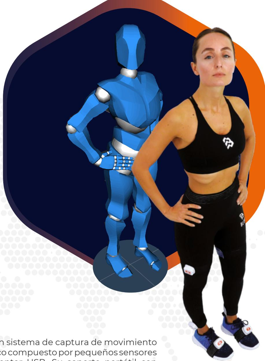
El **Movit Gait™** es un sistema de captura de movimiento portátil e inalámbrico compuesto por pequeños sensores inerciales y un receptor USB. Su soporte portátil con sistema de enganche/desenganche rápido hace posible posicionar fácilmente dispositivos sobre el sujeto. Al colocar los sensores en la parte inferior del cuerpo del paciente (pelvis, muslos, tibias y pies) da comienzo el análisis. Disponibles en la versión de 5,7 y de 16 sensores.
